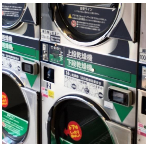
コインランドリー機器でのマルチ電子マネー決済を実現 左は洗濯機、右は乾燥機に取り付けた決済端末
