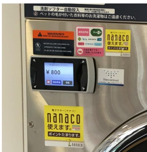
コインランドリー機器でのマルチ電子マネー決済を実現 左は洗濯機、右は乾燥機に取り付けた決済端末
